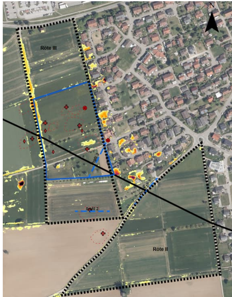
Abbildung 3: Hebungsbeträge >10 cm (gelb) bis max. 2,7 m (blau) basierend auf DGM-ALS1 und -AIS2. (Punkte = Sondierpunkte; Linien: rot = Muldenstrukturen, schwarz (gestrichelt) = Abgrenzung Erschließungsgebiete, schwarz = kartierte Störung, blau = Untersuchungsbereich Geophysik) [Detailansicht siehe Anlage 1C].
