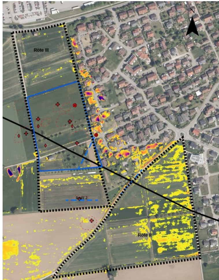
Abbildung 2: Setzungen >10 cm (gelb) bis max. 1,6 m (blau) basierend auf DGM-ALS1 und -ALS2. (Punkte = Sondierpunkte; Linien: rot = Muldenstrukturen, schwarz (gestrichelt) = Abgrenzung Erschließungsgebiete, schwarz = kartierte Störung, blau = Untersuchungsbereich Geophysik) [Detailansicht siehe Anlage 1B]
